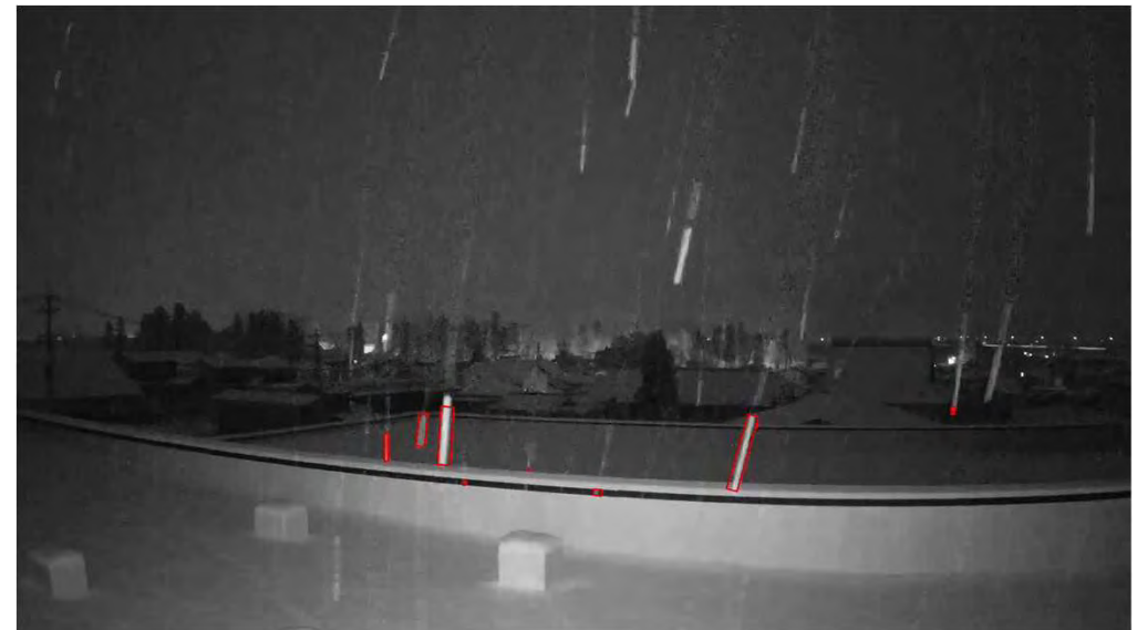
映像IoT情報による降雪の検知 (降雪部分を赤色表示)
